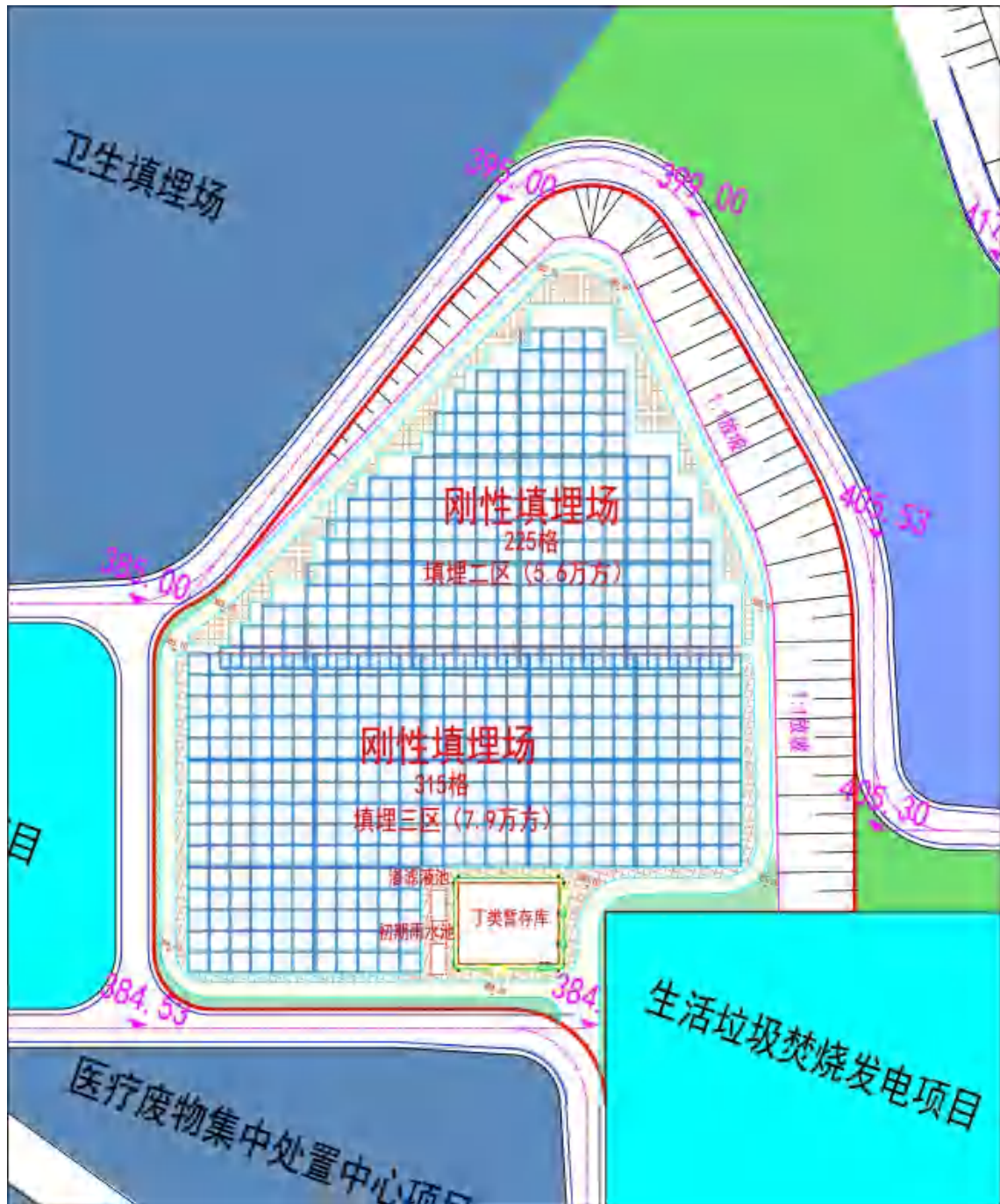
图 2.7-3 刚性填埋场填埋二区、三区平面布置图
