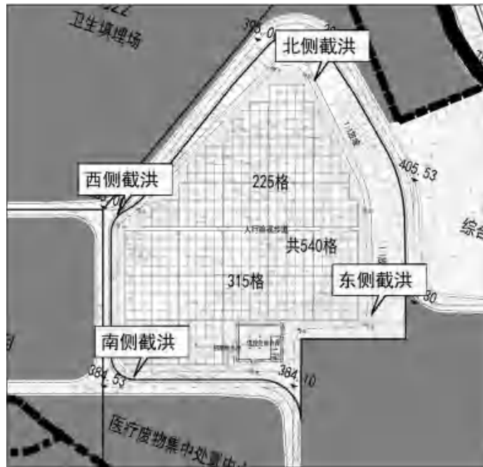
图 2.7-8 安全填埋厂区填埋场截洪沟平面布置图
