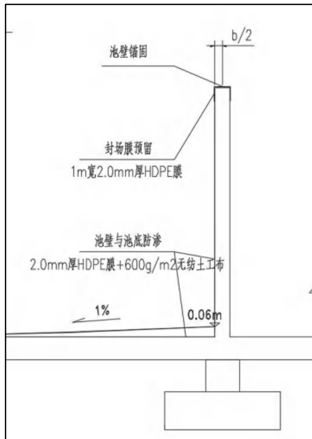
图 2.7-4 填埋池壁防渗结构示意图
